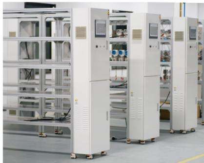
智能传感器大数据云端监测平台，是采用自动化传感器供电模块与高精度信号采集与存储模块、以及无线通讯模块组成。通过灵活的设置，可实现多种传感器的通电在线信号监测，并将信号自动发送到需要的云端，使用者可在多种移动终端上实时了解传感器的性能与长期稳定性，为传感器稳定性判断与出厂后信息追溯提供自动化解决方案。
